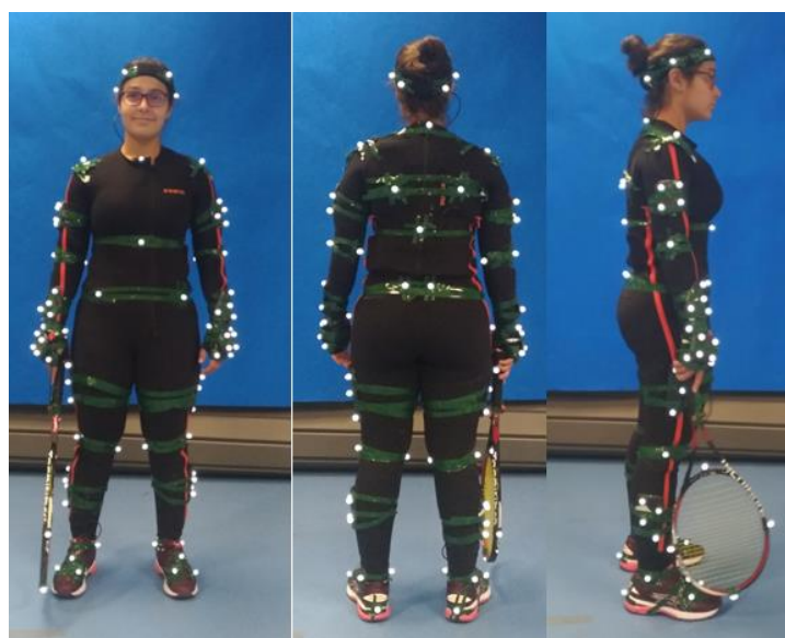
Figura 2. Set-up Individual. Protocolo de marcadores colocado em cada um dos segmentos com 43 marcas refletoras e 10 clusters com 4 marcas de seguimento não colineares.
